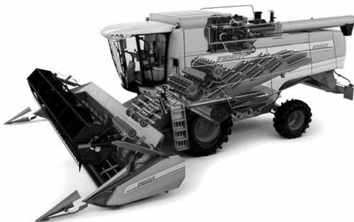
Rys. 3. Kombajn zbożowy FENDT 5270 w przekroju, moc silnika 275 KM, szer. cięcia 4,8 – 7,6m, pojemność zbiornika ziarna 9000 L
