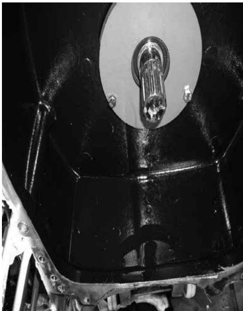
Rys. 7. Ciągnik Fendt 312 z niewidocznym przeciekiem wewnętrznym oraz nagromadzenie oleju w obudowie sprzęgła głównego
